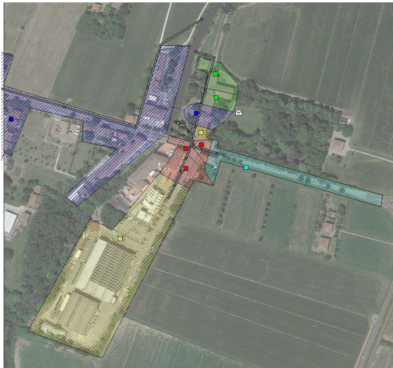
Figura 19: Schema della rete fognaria e dei bacini idrografici in cui è stata suddivisa la superficie della zona oggetto di studio
