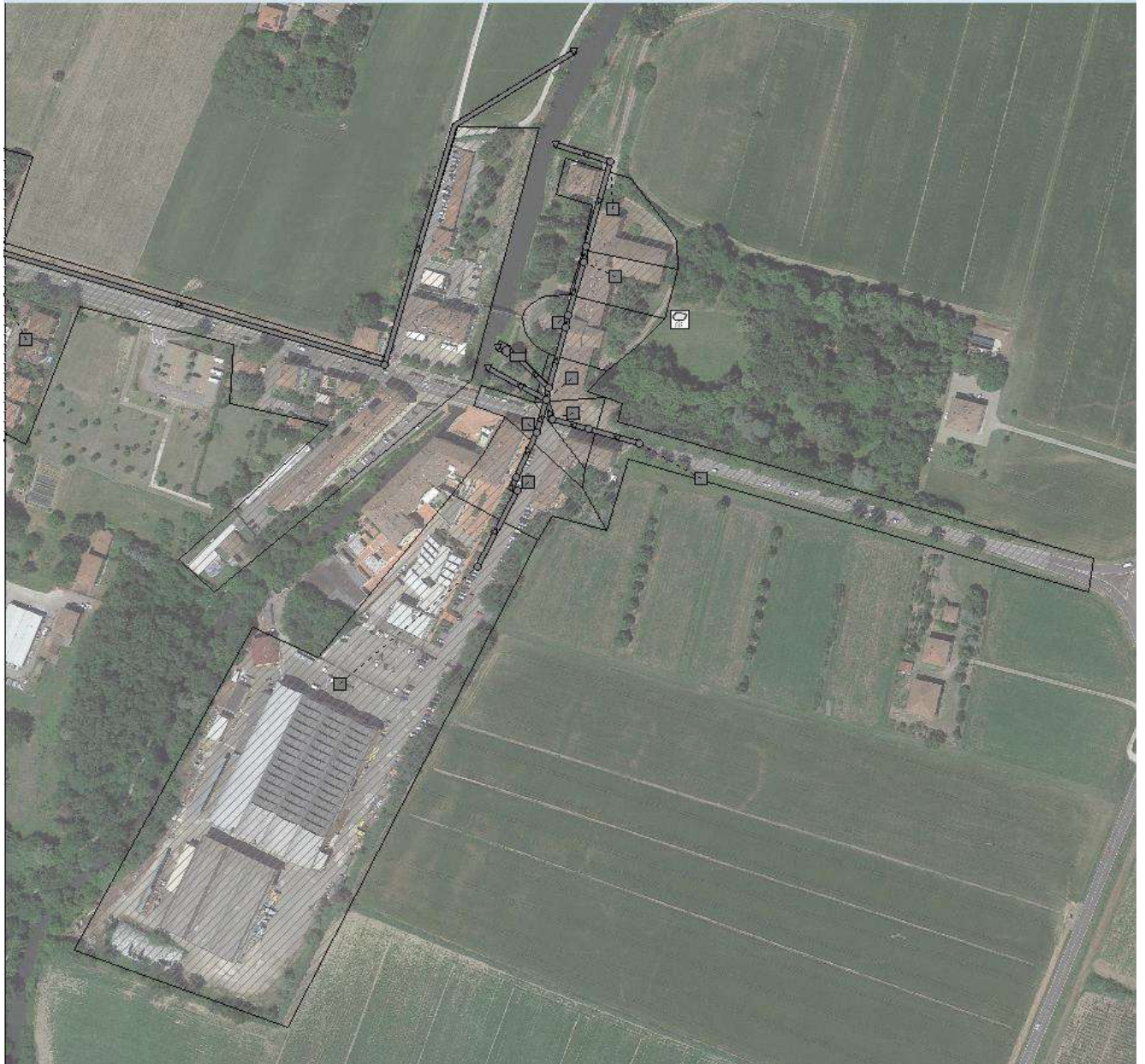
Figura 18: Schema della rete fognaria, con evidenziati i rami e i nodi, all'interno del codice di calcolo SWMM.
